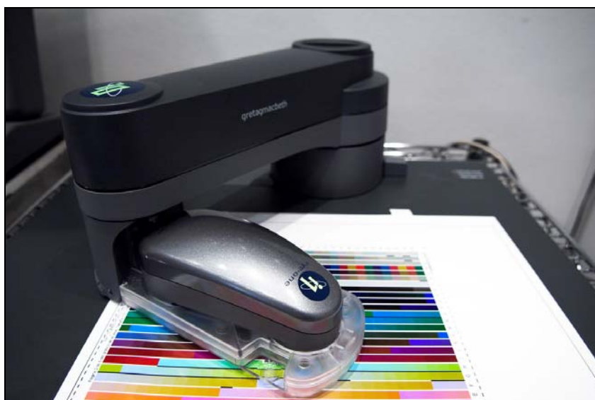
Calibrador profesional de alto rendimiento EyeOne iO.
