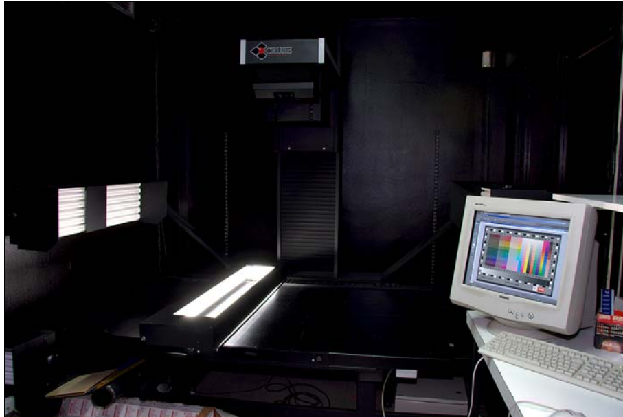
El escáner de gran formato CRUSE.
